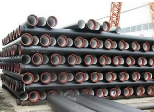
带有橡胶圈柔性接口的管材
